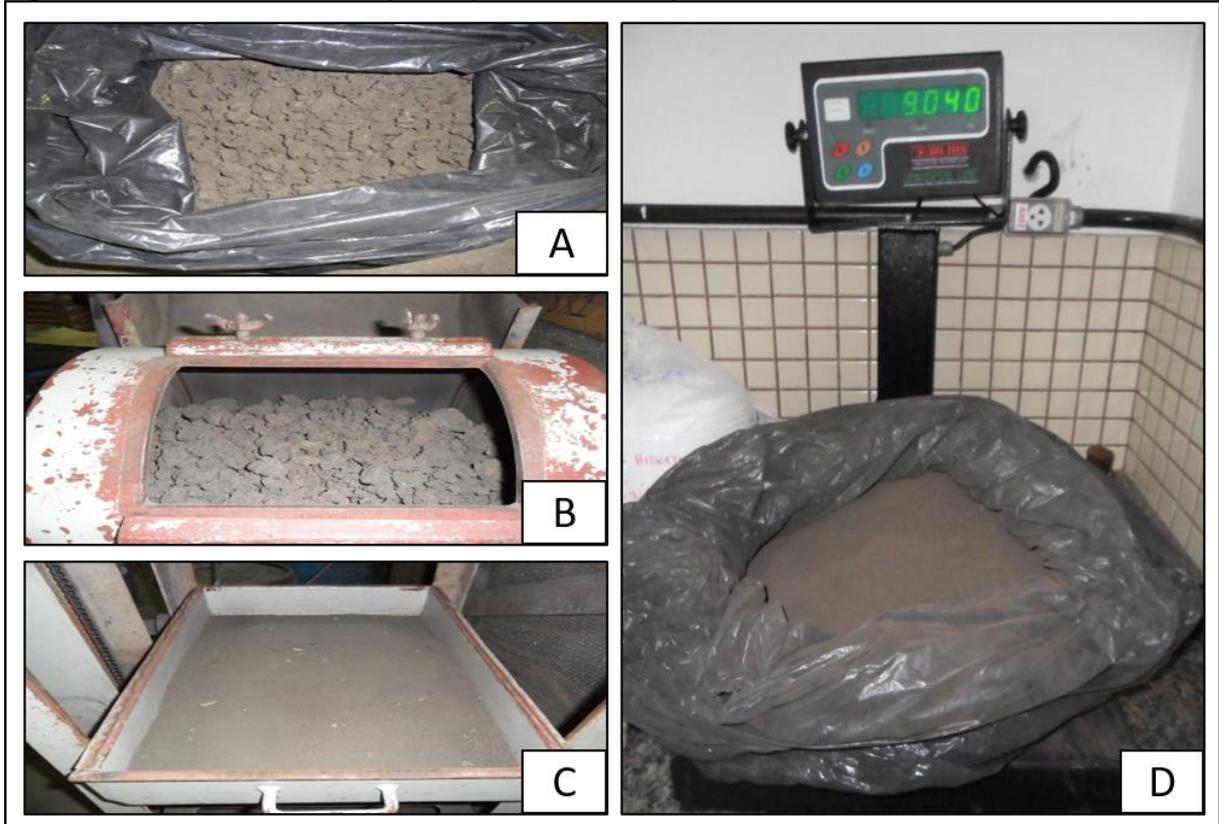
\***Legenda:** (a) lodo seco (b) desagregamento do lodo em moinho de bolas c) disposição do lodo em bandejas d) pesagem da massa em balança digital.
