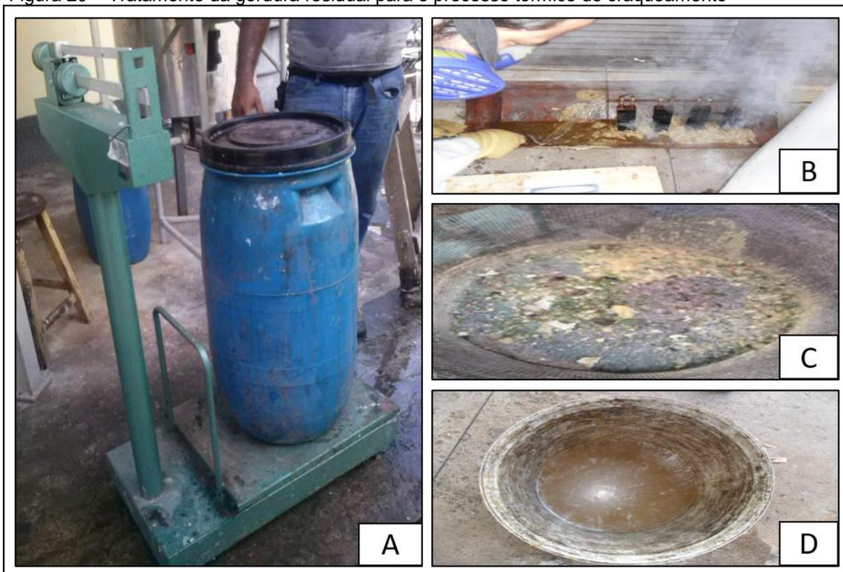
\***Legenda:** (a) pesagem do material (b) liquefação da gordura c) peneiramento do material grosseiro
